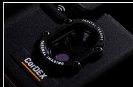
Wizja w podczerwieni z bardzo czułą matrycą termiczną 80x60.
