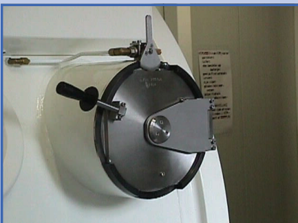
Śluza medyczna: wraz z wewnętrznym zamkiem bezpieczeństwa
